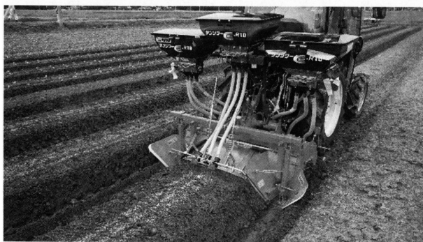
写真7. 表層作条施肥と畝内全層施肥の複合作業
